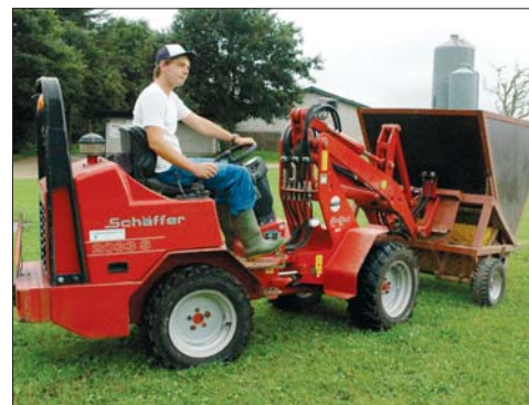
ARBEJDSLETTELE: Strømaskinen kan både monteres bag på og, som her, foran en minilæsser.
